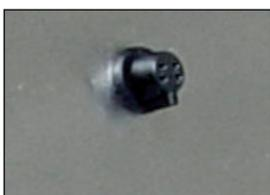
Externer Informationsausgang für Misceo, zur Nutzung von externen Signallampen, Signalhörnern oder zum Einbinden in die Maschinensteuerungen. Ausgabespannung 24VDC bei max. 0,5Amp.
