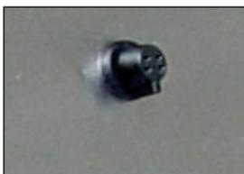
Externer Informationsausgang für Misceo, zur Nutzung von externen Signallampen, Signalhörnern oder zum Einbinden in die Maschinensteuerungen. Ausgabespannung 24VDC bei max. 0,5Amp. Inklusiv Anschlussplan und Anschlussstecker.
