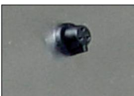
Ausgang für Überlaufüberwachung, Füllstandsschwimmer, Füllstandsüberwachung und Notausschaltungen.
